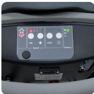
Pannello comandi analogico, semplice ed intuitivo. Selettore di regolazione velocità. Interruttore generale ON/OFF e interruttore a chiave, interruttore per motore spazzola e aspirazione. Disgiuntore termico per proteggere il motore spazzole e aspirazione, indicatore livello batteria, contatore.
